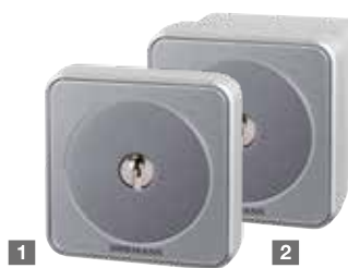
1 STUP 50 2 STAP 50 kulcsos kapcsoló Falba süllyesztett és falon kívüli kivitel, 3 kulccsal, RAL 9006 fehéralumínium színű horganyöntvény házban, nemesacél blendével
