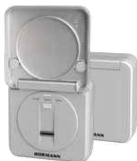
FFL 25 BS rádiós ujjlenyomat-olvasó 2 funkció, legfeljebb 25 ujjlenyomat tárolható, felcsapható fedéllel, falba süllyesztett és falon kívüli szerelés is lehetséges, RAL 9006 fehéralumínium színű műanyag házban
